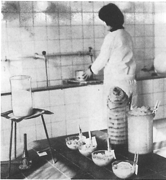
Abb. 14. Arbeitsplatz in einem Mikrolabor. Vorn links wird eine \text{H}_2\text{O}_2 -Probe erhitzt. Die rechts stehenden Bechergläser enthalten mit \text{H}_2\text{O}_2 (15%) frisch angesetzte Tone. Das hintere Glas kocht bereits über. In den vor den beiden Bechergläsern stehenden Abdampfschalen befindet sich mit Glaubersalz angesetzte Kreide. Kleine Zettel mit den speziellen Angaben zu der bearbeiteten Probe sind mit Klammern an den Gefäßen befestigt. Im Hintergrund arbeitet eine Laborantin mit einem Siebsatz am Schlammbecken
